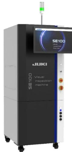
SE100 は、15cm 角以内の多種多様な金属部品のキズ・打痕・欠け・巣穴・錆・多肉など各種の不良検査を約 1 秒(2D 検査)のスピードで行う装置です。
