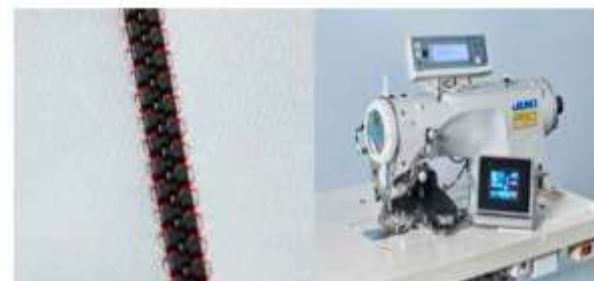
テープを無くした新タイプのファスナー「AiryString™」を「AiryString™」(2019年7月リリース) 縫製する専用マシン
