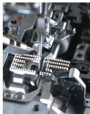
MF-7900における結び目を作る機構
