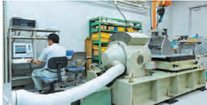
加振機を活用しての振動試験
