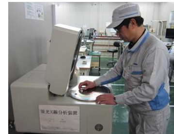
蛍光X線分析装置での有害物質含有検査
