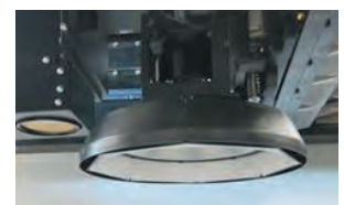
自動車のエンジン部品や機械部品を検査する「ハイブリッド外観検査機」
