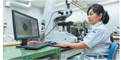
ビッカース硬度計での硬さ試験
