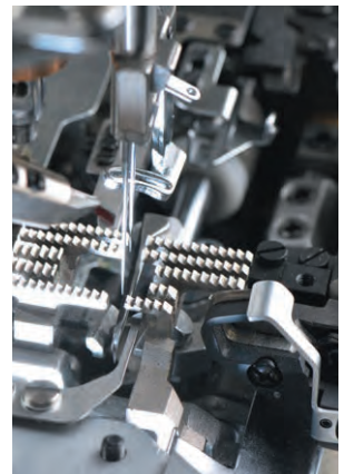
MF-7900における結び目を作る機構
