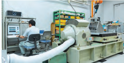
加振機を活用しての振動試験
