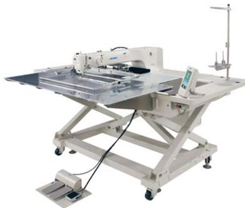
高い縫い品質と生産性、操作性に加え、省エネも実現した大型エリア用電子サイクルマシン
