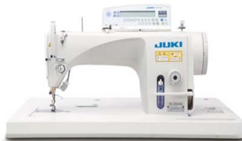
縫い始めの鳥の巣(糸の絡まり)を無くし、縫い終りの糸残り量を短くして製品の縫い品質を更に向上
