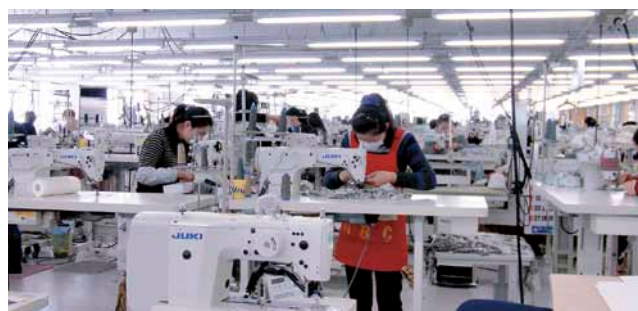
左写真の隣に建設した縫製工場。すべて立ちミシン。イタバシニット様独自の生産システムも復活させるため、この工場だけでは狭く、左の建物を復旧中。
