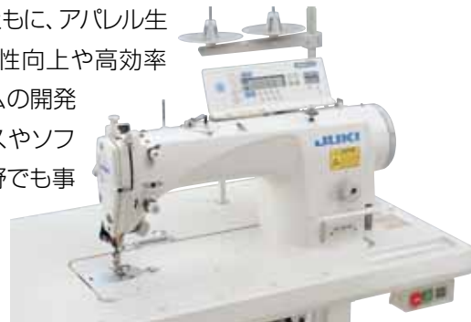
ベルトなしで駆動するダイレクトドライブ方式のドライヘッドミシン
