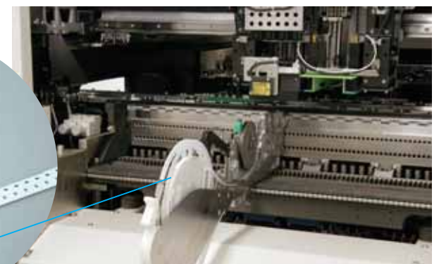
紙とプラスチックが分別しやすいように排出される、テープフィーダー方式
