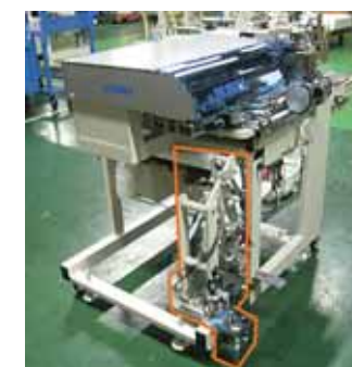
改善後の内部に収納されたスタッカー
