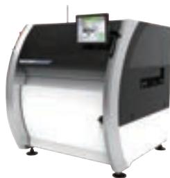
印刷機は、部品をはんだ付けするためにペースト状のはんだをプリント基板に印刷する装置で、基板組立工程の品質を大きく左右します。「RP-1」は、プリント基板とスクリーンマスクの位置合わせを行う新機構「モーションスクリーン」により、印刷の精度と生産性が大きく向上しました。
