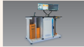
部品受入登録システム Incoming Material Station 受入作業が効率的になり作業ミスを削減
