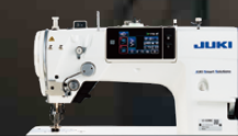
セミドライヘッド電子本縫千鳥縫 ソーイングシステム LZ-2290C
