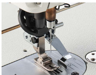
吊り定規使用例
