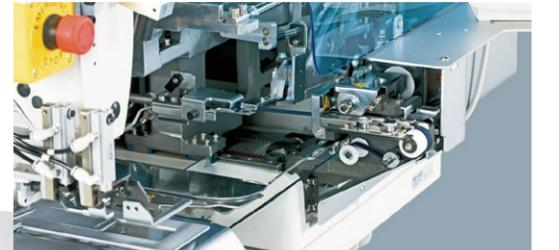
ループ供給装置にはJUKI独自のツイン方式を採用。柔らかく延びる素材でも安定したループ供給が可能です。供給装置を本体手前に配置したことで、ループを手前から挿入できループ交換が簡単です。縫製中も随時ループ状態が目視できます。
