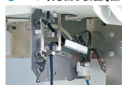
本体ループ供給装置のベルトループ送り出しを補助するループ引き出し装置です。次の縫製に必要なベルトループを予め引出すことで延び易い生地で作られたループでも、長さのバラツキを抑える事ができます。また、ベルトループの絡まりによる供給不良を検出します。
