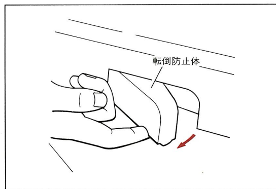
転倒防止体を引き出します
