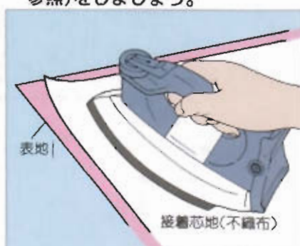
裏面に接着芯地(不織布)をアイロンで接着させます。(アイロン温度は低温～中温です) *不織布の接着芯地は仮接着タイプを使います。
