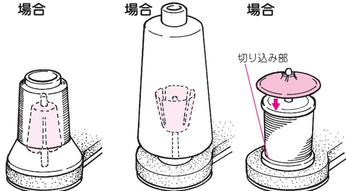
内径の大きい糸巻き糸は糸巻振れ止めを逆さにします。
