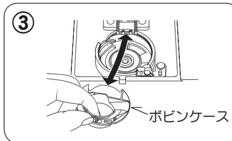
③ ボビンケースを図のように持ち上げて取り出します。ボビンケースに付着した糸くずも取り除いておきます。
