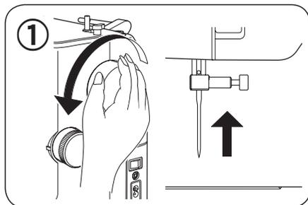
① 押えをはずし、はずみ車（プーリー）を手前に回して、針を最上点に上げます。
