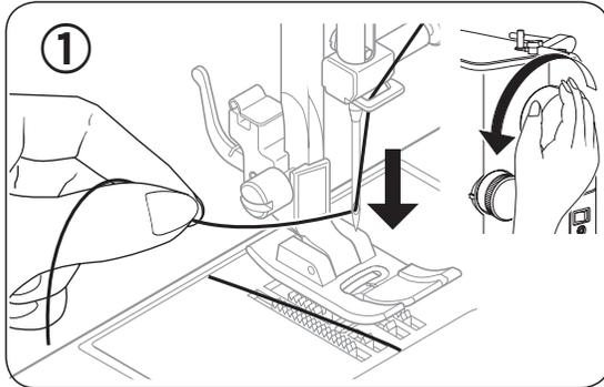
① 押え上げレバーを上げてください。針糸を軽く左手で持ち、はずみ車（プーリー）を手前に完全に一回転させてください。
