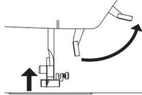
c. はずみ車(プーリー)を手前に回して、天秤を最上点に上げます。
