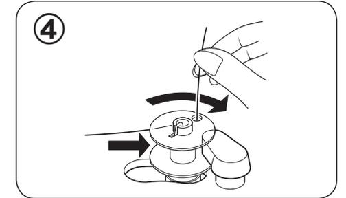
④ 糸の端を持ち、ボビンをカチッと音がするまで右に押します。スピードコントロールつまみでスピードを調整し、スタート/ストップスイッチを押して糸を巻きます。
