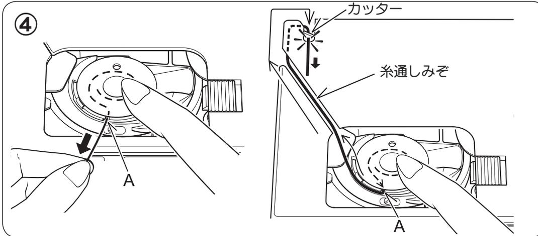
④ ボビンを指で押さえながら、糸を手前のみぞAに通し、その糸を針板の糸通しみぞに沿って糸を通し、手前に引いて、カッターで糸を切ります。
