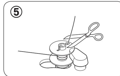
⑤ ボビンが数回転したらいったん止め、巻き始めの糸を切ったあと、再度スタート/ストップスイッチを押して糸を巻き続けます。
