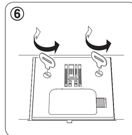
⑥ 専用ドライバーでネジをしっかりしめて、針板を取り付けます。
