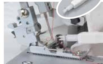
付属の針糸通し器を使うと面倒な針穴への糸通しもワンタッチで完了。スピーディーに作業をスタートできます。
