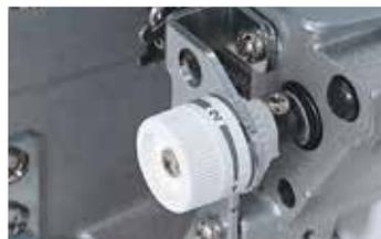
布地の種類によってメス位置の調節ができます。布の端がカールしたり、糸が余った時などに、つまみを回すだけでカンタンにメス幅を調節できます。
