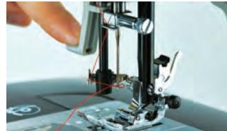
針穴への糸通しもワンタッチで完了するので、スピーディに作業をスタートできます。
