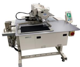
下糸自動糸巻供給装置 (半回転釜AMS-ENシリーズ後付け用) AW-3S (2022年2月認定)
